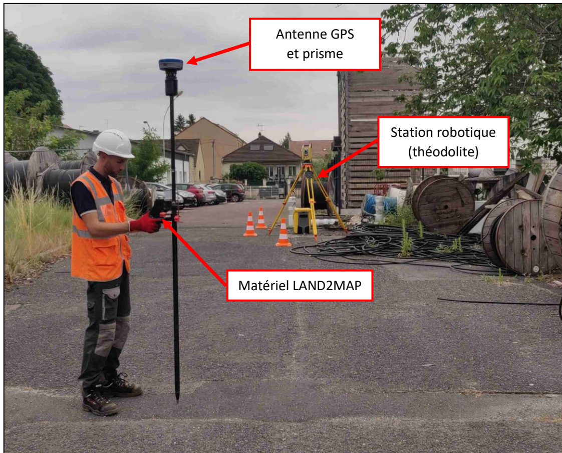
Figure 12 : Relevé topographique par station robotisée
