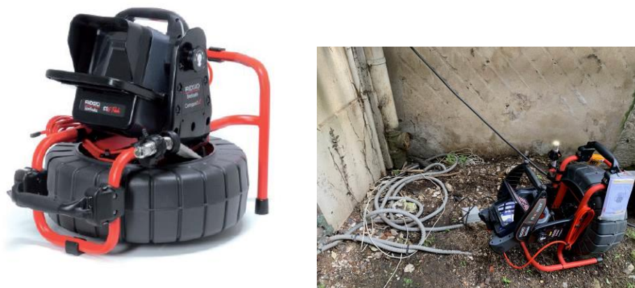
Figure 5: aperçu de la caméra de canalisation et de sa mise en œuvre au niveau du réseau d'évacuation N°2
